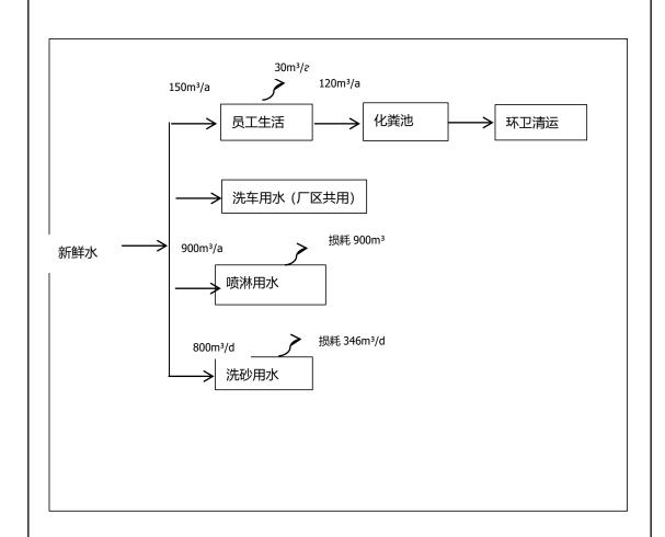
图 1 用水平衡图
